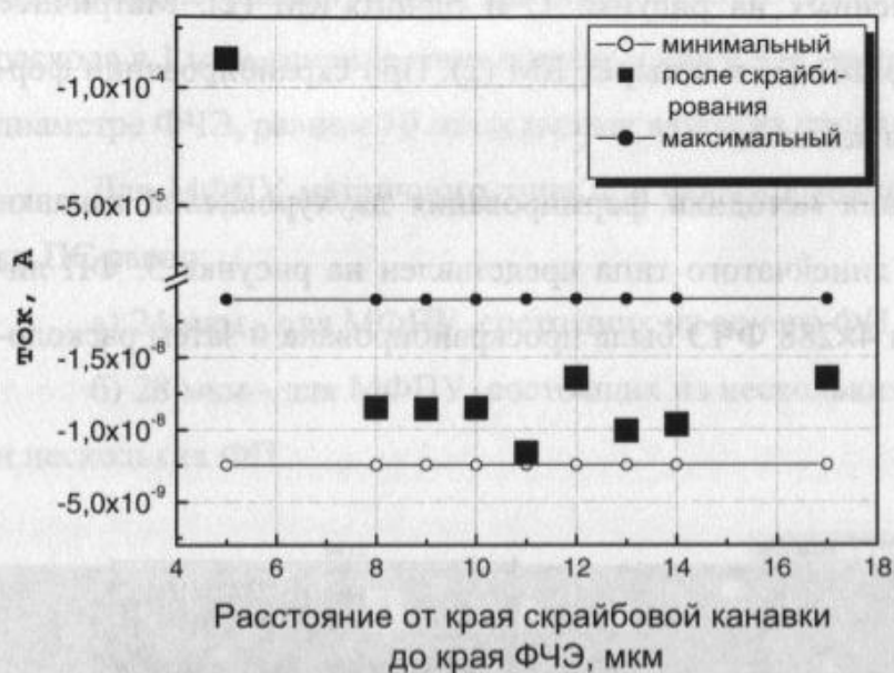
Рисунок 3 - Зависимость изменения значений «темных» токов через ФЧЭ при обратном напряжении смещения минус 0,2 В от расстояния до канавки. Область между двумя линиями показывает разброс значений токов через ФЧЭ в контрольной группе, вдоль которых скрайбирование не производилось.
