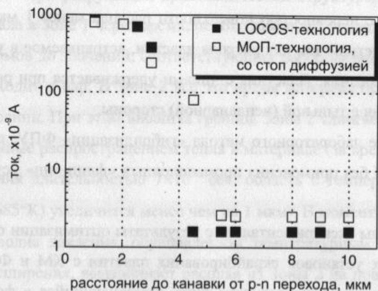
Рисунок 2 – Изменение тока при обратном включении р-п переходов в КМ в зависимости от расстояния до скрайбовой канавки. Напряжение на р-п переходах равно 8,2 В. КМ изготовлены по технологиям «LOCOS» и МОП со стоп - диффузией.
