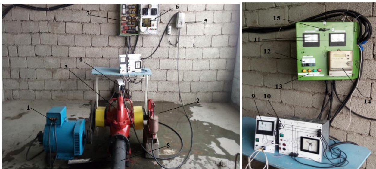
Рисунок 17 – Внешний вид экспериментальной установки с системой защиты от механических поломок или попадания инородного тела в гидротурбину
