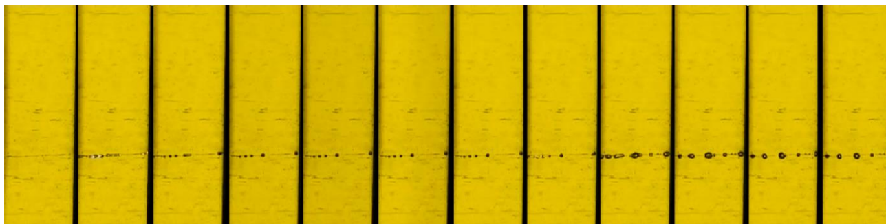
Рисунок 5 – Пробой углеродного мостика из агломератов наночастиц
