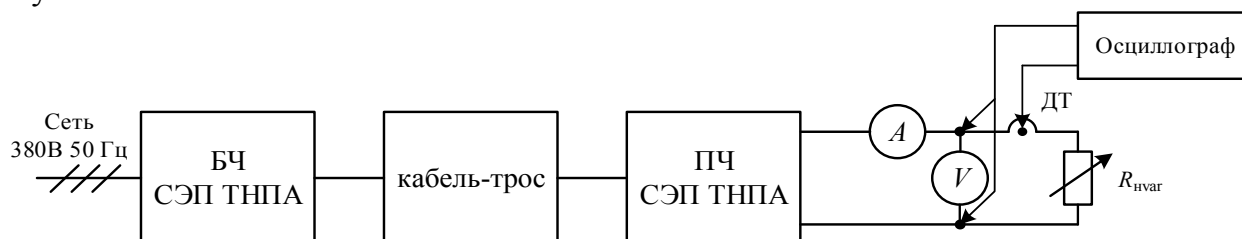
Рисунок 27 – Функциональная схема экспериментальной установки для исследования выходных электрических параметров СЭП ТНПА
